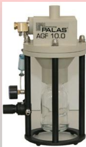
Der Aerosolgenerator von Palas (auch Seedinggenerator) ist ein Flüssigkeitsvernebler. Das Fluid (z.B. Silikon) wird hierbei in 10\ \mu\text{m} große sphärische Partikel zerstäubt und an das System abgegeben. In diesem Versuch ist der Seedinggenerator an den Ring 1 angeschlossen.
